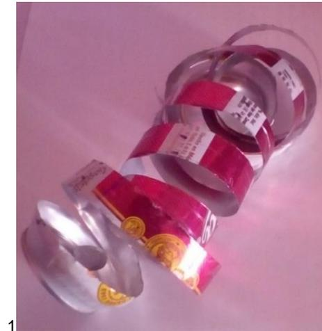
Figura 22. Materia prima de lata de aluminio. En la imagen 1 se muestra que a través del proceso de corte se puede obtener un material con características específicas. En la imagen 2 se observa que el subproducto obtenido al desprenderse de los extremos de las latas se tiene un material de 2 cm de ancho y con una longitud de 2.5 metros.
