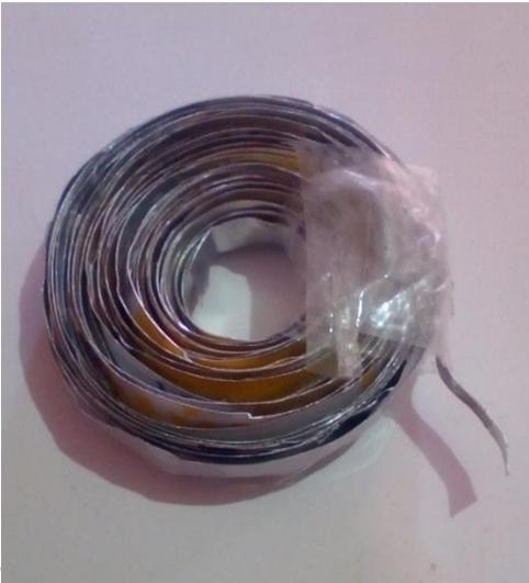
Figura 23. Materia prima de latas de aluminio. En la imagen 1 se muestra que a través del proceso de corte y trefilado se puede obtener un material con características idóneas para realizar filamentos. En la imagen 2 se presenta un subproducto obtenido del corte y trefilado de
