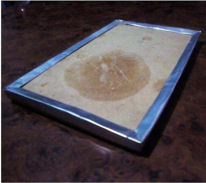
Figura 25. Subproducto del material obtenido de las latas de aluminio. Cañuela para protección de filos y esquinas. Elaboración propia 2019.
